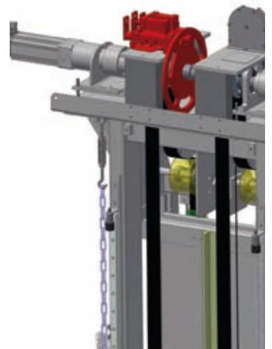
ABS Sicherheitsabsteckung Antriebswelle Lochscheibe
